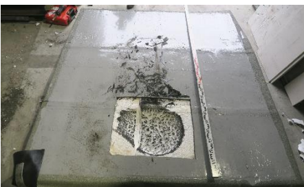
Abbildung 8: Brandschaden der EPS-Dämmung nach Prüfung nach CLC/TR 50670
