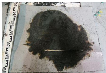
Abbildung 9: Brandabschnitt aus CLC/TR 50670 Prüfung für Stauwasserprüfung
