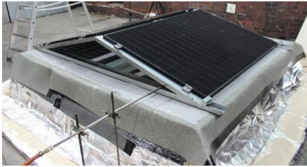
Abbildung 6: Aufbau Prüfung nach CLC/TR 50670
